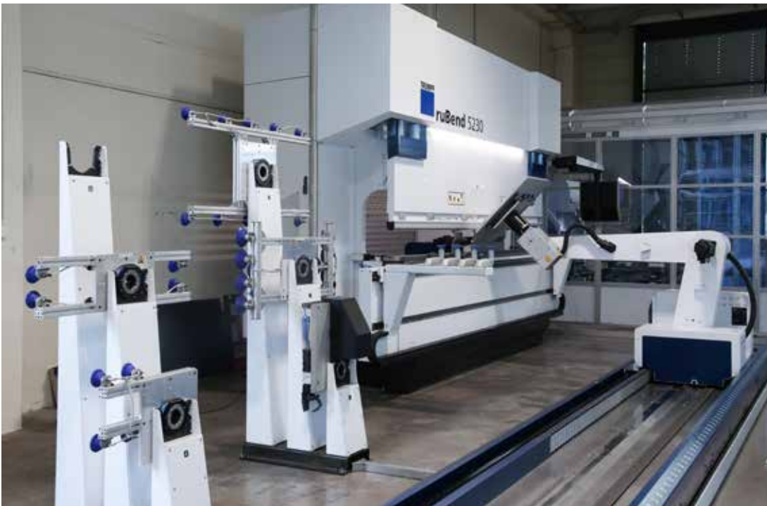
Ein selbständiger Greiferwechsel aus der Greiferstation erlaubt ein automatisches Abarbeiten verschiedener Aufträge ohne manuellen Eingriff.
