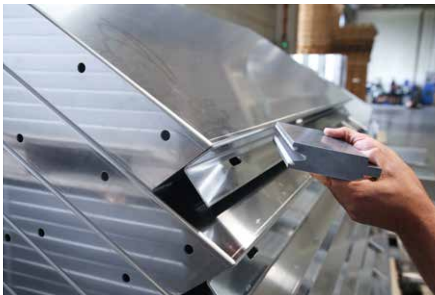
Abdruck- und kratzfreies Kanten: Abkantwerkzeuge mit einer fixen Kunststoffleiste in der Matrize.
